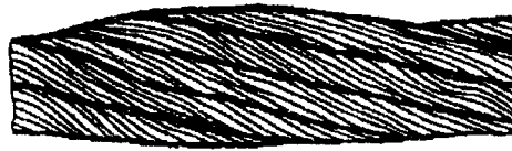
Рисунок 13. Местное увеличение диаметра каната
