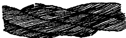
Рисунок 1. Обрывы и смещения проволок каната крестовой свивки
